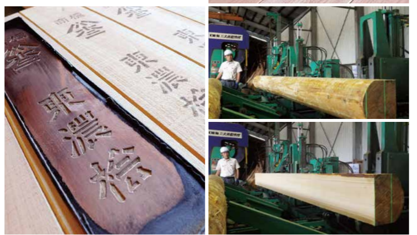
丸太を製材機にかける様子[粗挽き]
